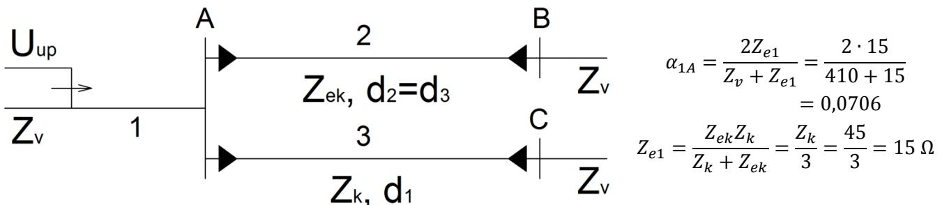
Ekvivalentna impedansa ova dva kabla, ne uzima se  $Z_v$  zato što vodovi nisu neposredno iza sabirnica A.
