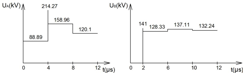
$t_r = 2 \mu\text{s}$ , trenutak reagovanja odvodnika prenapona.
