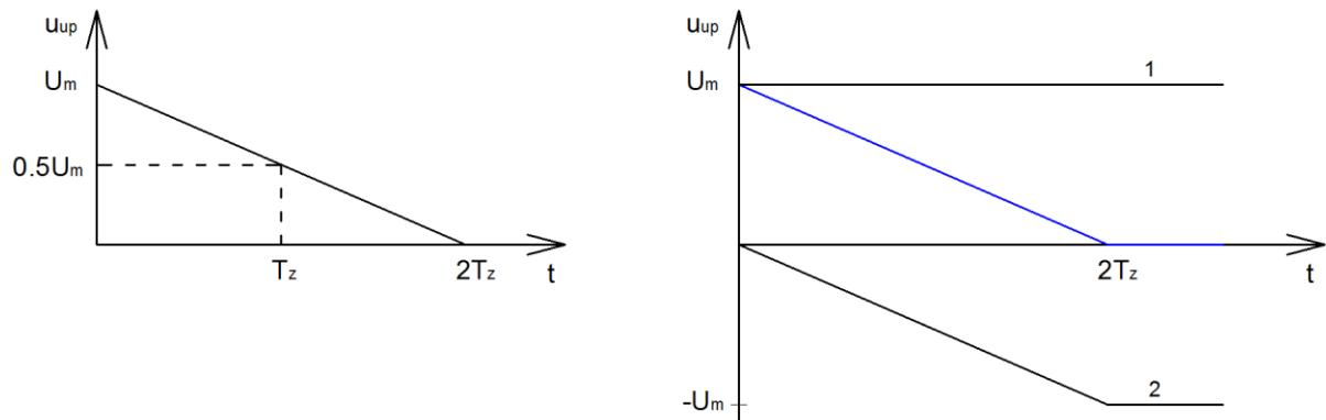
$$u_{up}(t) = \underbrace{U_m h(t)}_1 - \underbrace{\left( a h(t) - a(t - 2T_z) h(t - 2T_z) \right)}_2$$
