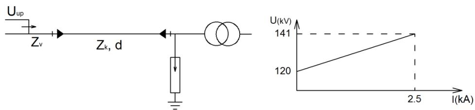
Pošto se koristi SiC odvodnik prenapona smatra se da nije reagovao. Kada se postigne  $U_{100\%}$  odvodnika prenapona on reaguje i koristi se karakteristika koja se odnosi na nelinearni otpornik.
