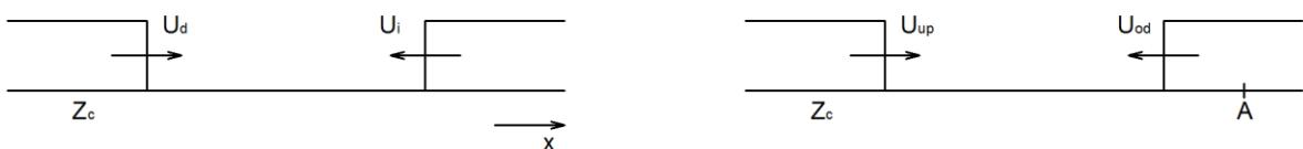
$U = U_d + U_i$ ; gde je  $U_d$  direktna komponenta naponskog talasa koji se kreće u pravcu povećanja x ose,  $U_i$  inverzna komponenta naponskog talasa koji se kreće u pravcu suprotnom od x ose.
