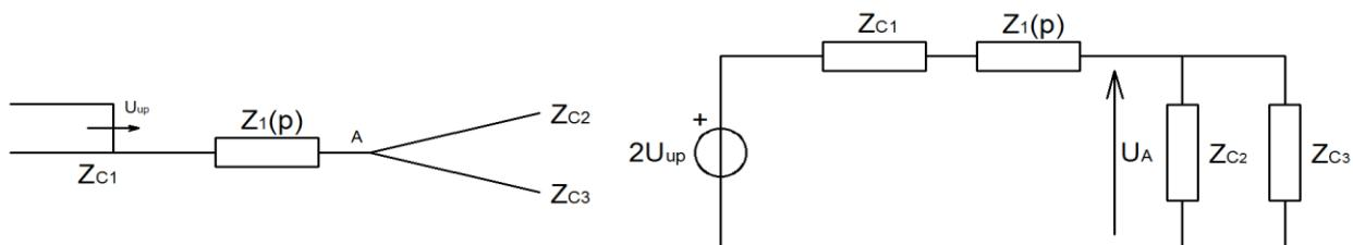
5) Prenaponski talas atmosferskog porekla nastao direktnim udarom groma u fazni provodnik dalekovoda nailazi na sabirnice postrojenja na kojima je priključeno još pet vodova. Odrediti oblik i veličinu napona na sabirnicama u slučaju:
