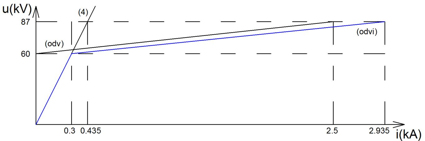
Određivanje ekvivalentne inverzne karakteristike odvodnika prenapona i vodova.
